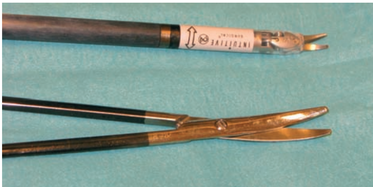
Bild 7. Robotens miniatyrinstrument möjliggör bättre precisionen vid operationen, en robotsax i jämförelse med en sax som används vid öppen kirurgi.
