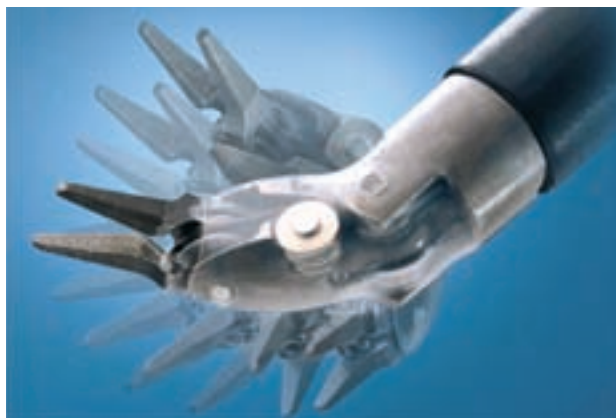
Bild 6. Endowrist, ett robotinstrument med överlägsen rörelsefrihet i jämförelse med människans hand.
