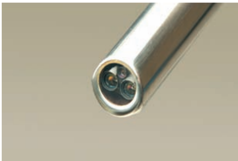
Bild 4. Endoscope, två videokameror synkroniseras till att skapa en 3D-bild i konsolen.
