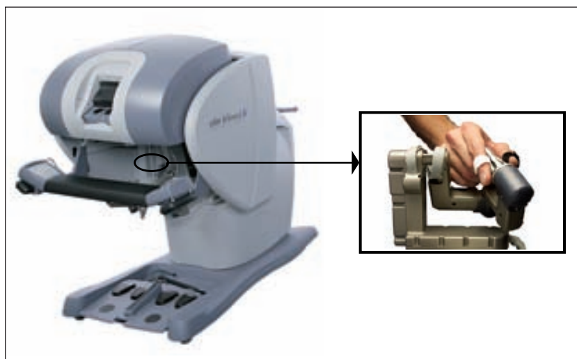
Bild 1. Robotkonsol (master). Urologen får sin 3D-bild genom att titta i konsolen. Robotarmarna styrs med hjälp av två handtag (detaljbilden).
