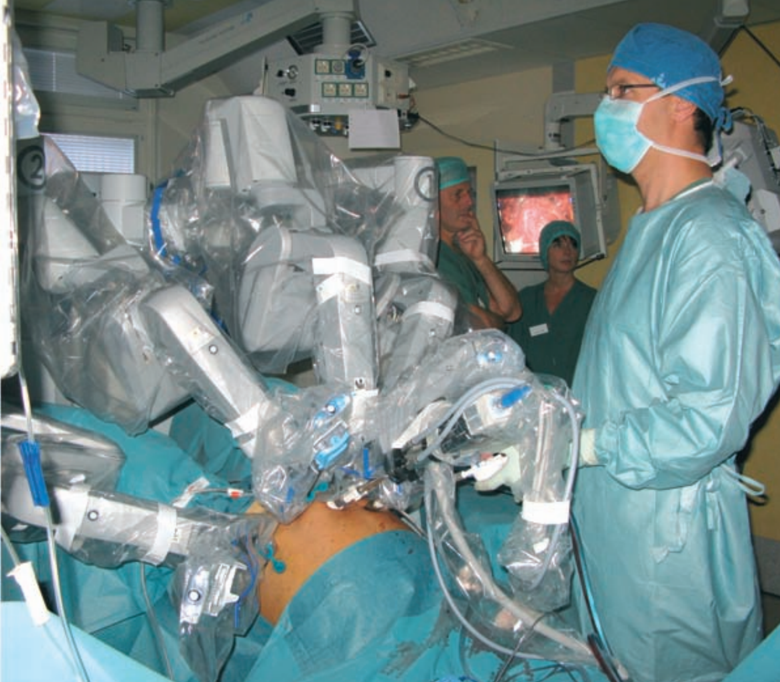
Bild 5. Robotarmar "dockas", armarna är kopplade till portarna.
