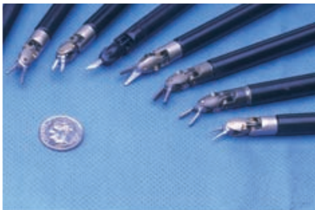
Bild 6. Endowrist, ett robotinstrument med överlägsen rörelsefrihet i jämförelse med människans hand.
