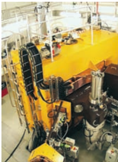
I denna Scanditronix MC32-cyklotron vid PET och cyklotronenheten vid Rigshospitalet i Köpenhamn produceras det Astat-211 TAT-gruppen använder i sina försök.
